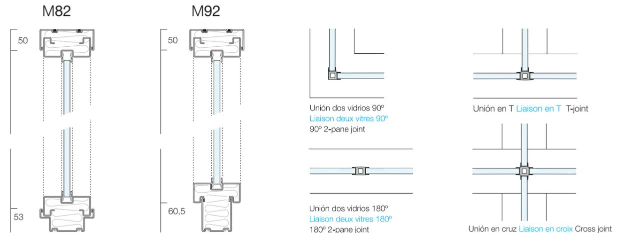
**Coronación y rodapié:** de acero galvanizado, como en los sistemas M82 y M92. Únicamente cambian los junquillos para aceptar vidrios de mayor grosor.
